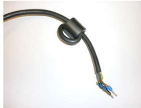
Figura 1: Montaggio della ferrite sul cavo di rete
